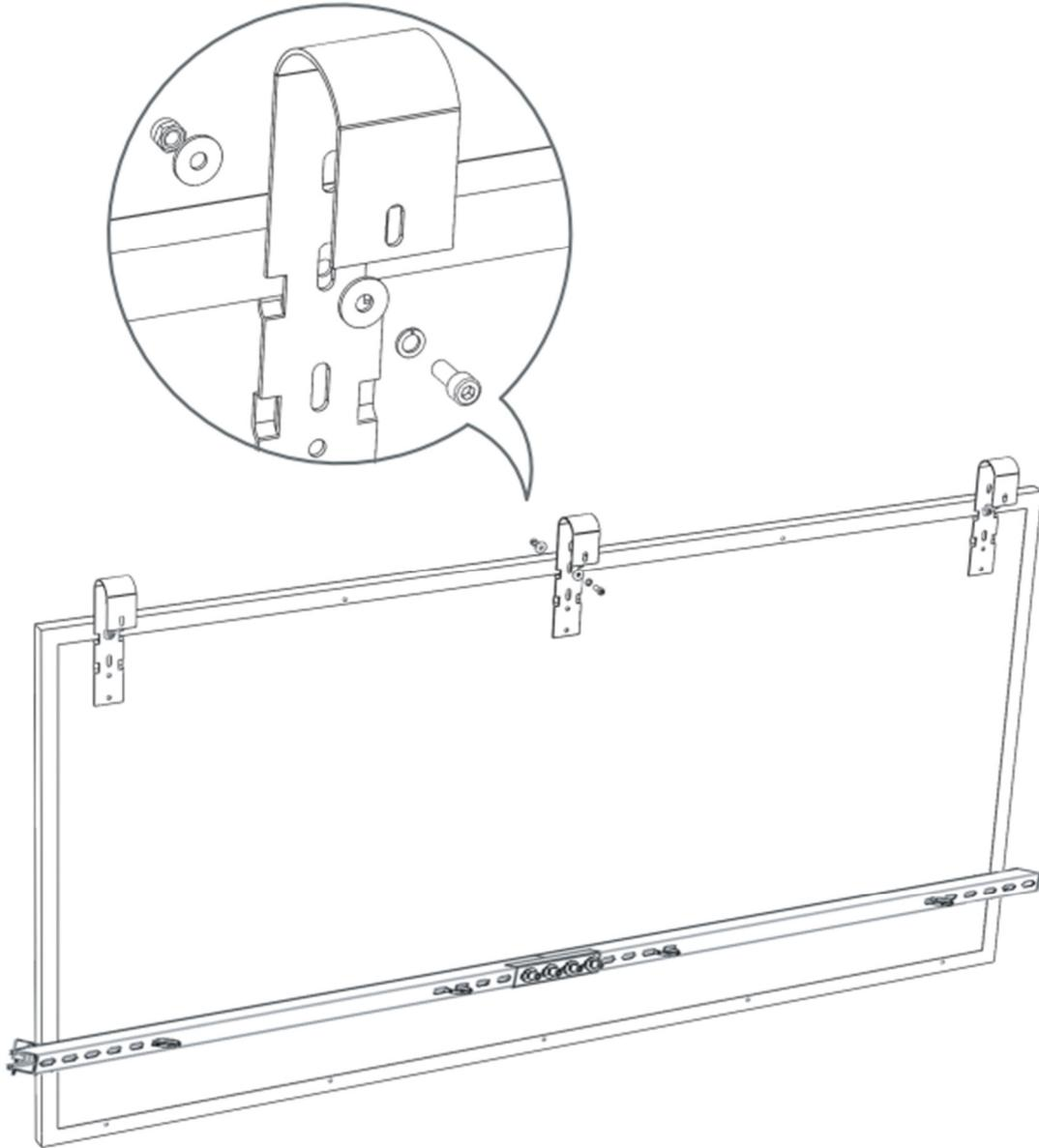
4. Das Solarpanel an das Balkongeländer hängen und die J-Haken mit jeweils einer M8\*90-Schraube fixieren
