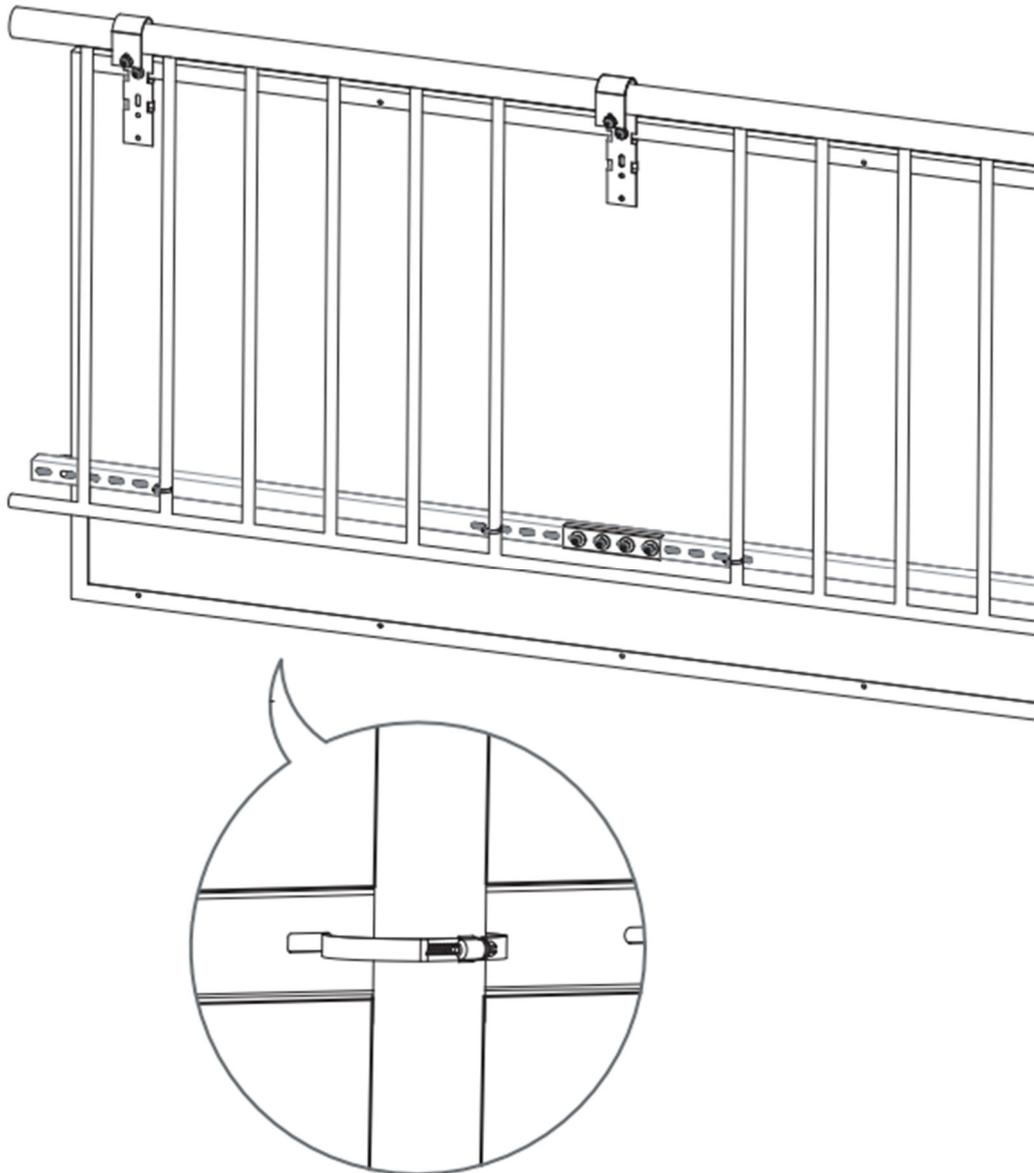
6. Alle Schrauben und Muttern zur Sicherung des Systems fest anziehen
