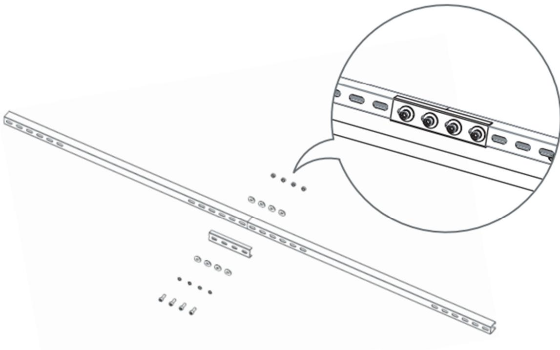
2. Das Solarpanel mit den Endklemmen und M8\*30-Schrauben an die am Balkon befestigte Schiene montieren
